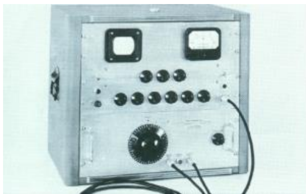
1949 – Varian F6: primeiro medidor de fluxo nuclear comercializado empregando os princípios da RMN.
